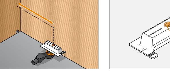
1 Das Ablaufgehäuse incl. Adapter mittig auf der Tragkonstruktion (ggf. auf geeigneter Trittschalldämzung) positionieren.
